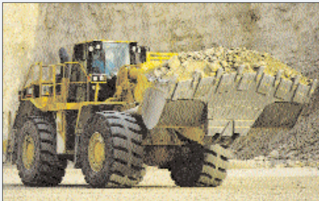
CAT 988 G mit 6,4-m 3 -Schaufel, diese ist ausgerüstet mit Trapezmesser, Zähnen und Unterschraubsegmenten. (Foto: Zeppelin Baumaschinen)
