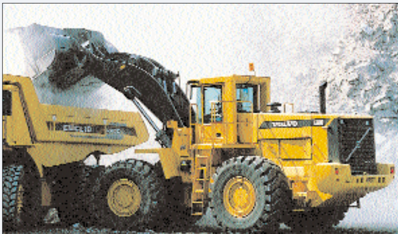
Volvo L 330 D, der größte Volvo-Radlader mit mehr als 50 t Einsatzgewicht – hier am Haufwerk beim Beladen eines Euclid-Muldenkippers. (Foto: Volvo Construction Equipment)
