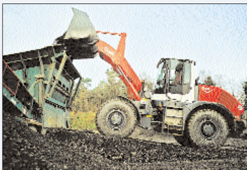
Vom Prototypen zum ausgereiften Seriengerät: der L 25.5 mit Universalkinematik. (Foto: O & K)
